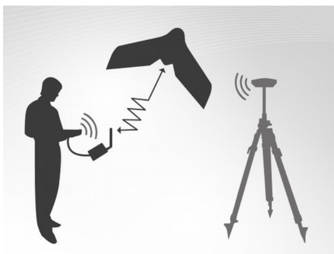
Figura 10: Componentes do Sistema de mapeamento aéreo com RTK (RTK base)
